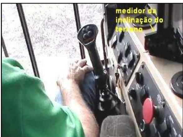
FIGURA 23 - painel à direita do operador do Feller-Buncher.
