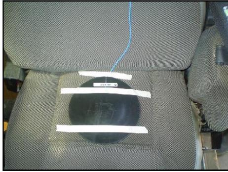
FIGURA 11- Acelerômetro fixo no assento da máquina
