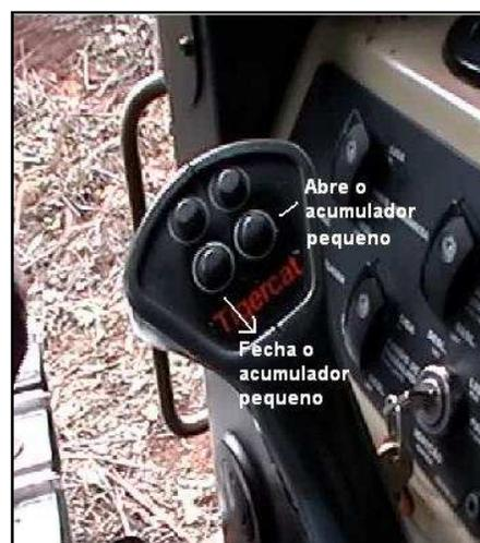
FIGURA 53 - *Joystick* Direito - Feller-Buncher
