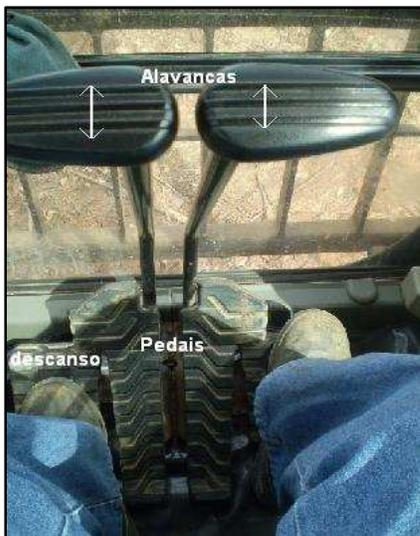
FIGURA 32 - Alavancas e pedais Garra Traçadora
