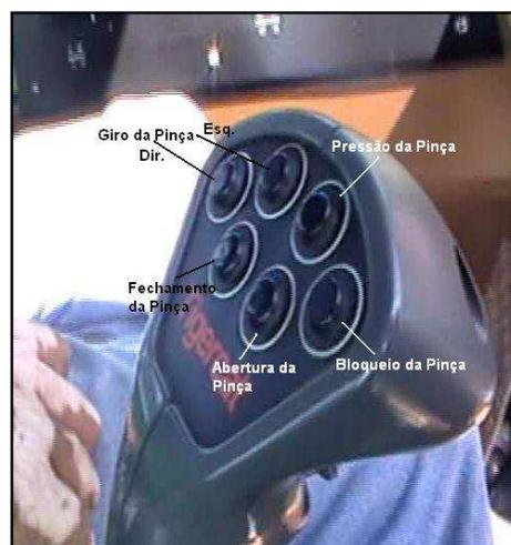
FIGURA 62 - Joystick Direito Skidder 635D
