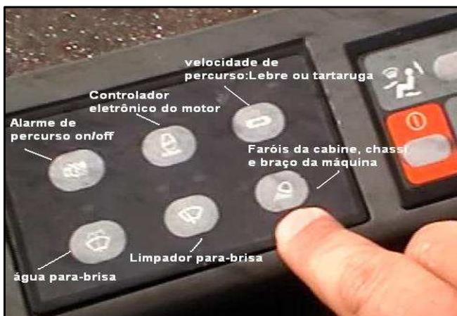
FIGURA 37 - Painel a direita do operador
