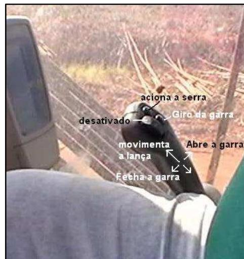
FIGURA 33 - Joystick direito – Garra Traçadora
