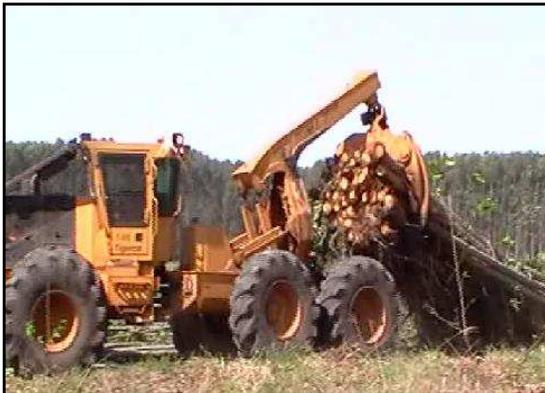
FIGURA 63-Deslocamento carregado Skidder 635 D
