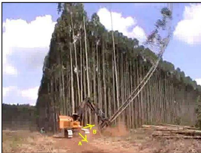
FIGURA 57 - A é o sentido do deslocamento e B é o posicionamento da cabine do Feller-Buncher.
