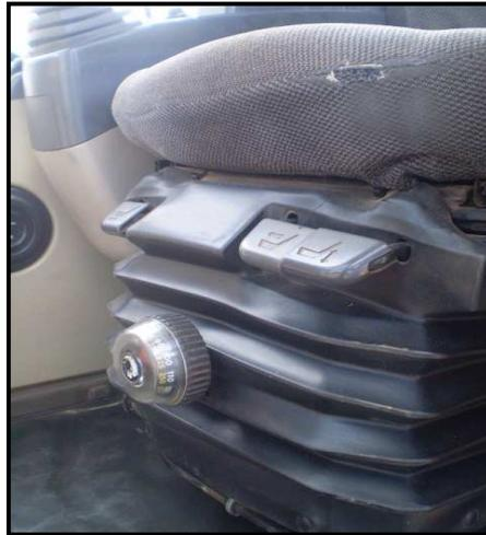
FIGURA 40 – Assento com amortecedor pneumático com regulagem da calibragem.
