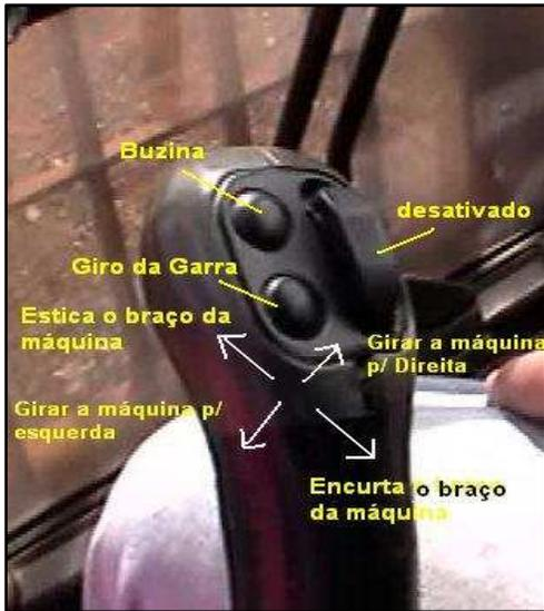
FIGURA 34 - Joystick esquerdo – Garra Traçadora
