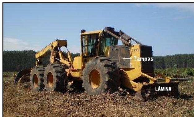
FIGURA 59 - Localização das tampas no corpo da máquina e da lâmina.
