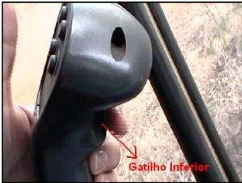
FIGURA 54 - Gatilho *joystick* - Feller-Buncher
