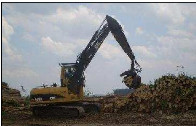
FIGURA 20 - Garra-Traçadora 320 CL – Caterpillar.
