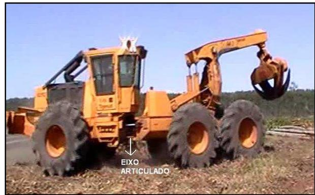
FIGURA 64 - Eixo articulado Skidder 635 D
