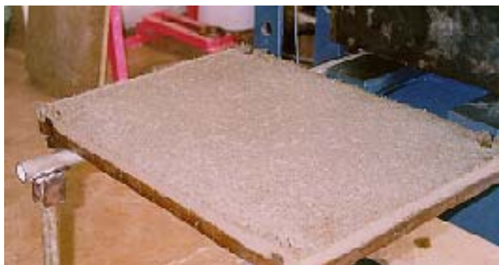
Figura 7- Placas após a desmoldagem
