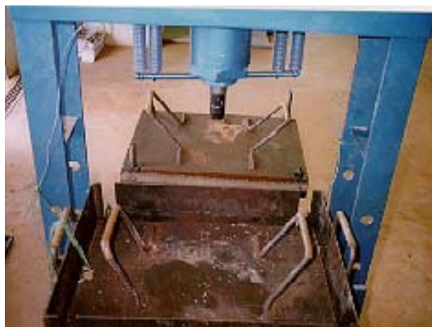
Figura 6- Prensa hidráulica Charlotte PH-30.
