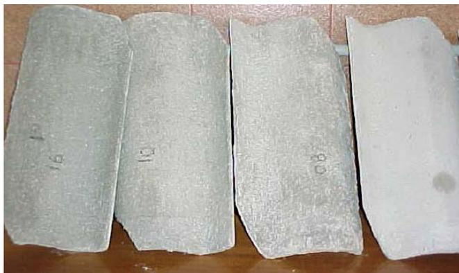
Figura 4.12 - Vista da superfície inferior de algumas telhas ensaiadas após o ensaio de permeabilidade.
