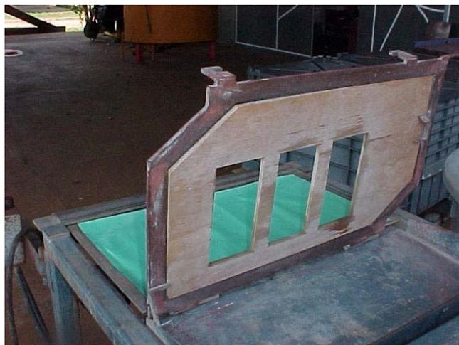
Figura 3.4 - Dispositivo utilizado para a produção dos CP para determinação da variação dimensional
