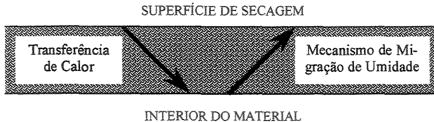
Figura 2: Diagrama da migração interna de água no sólido.
