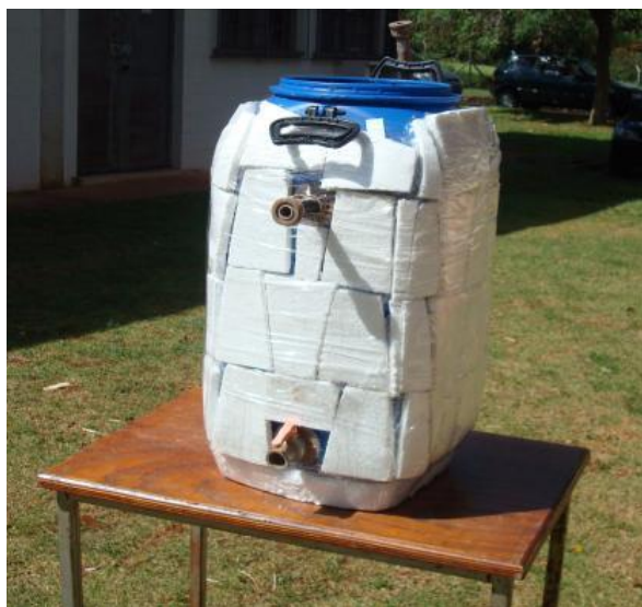
Figura 25: Reservatório de 40 litros revestido com isopor
