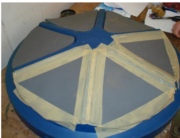
Figura 19: Caixa do Reservatório de 80 litros revestida com manta térmica
