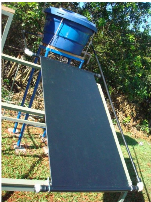
Figura 7: Aquecedor Solar de Baixo Custo construído de placa de PVC.
