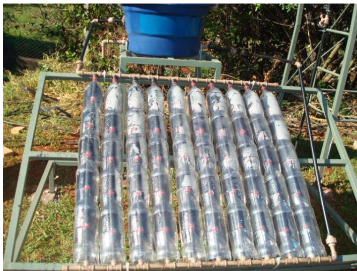
Figura 6: Aquecedor Solar de Baixo Custo constituído de garrafa PET e Caixas de Leite Longa Vida.
