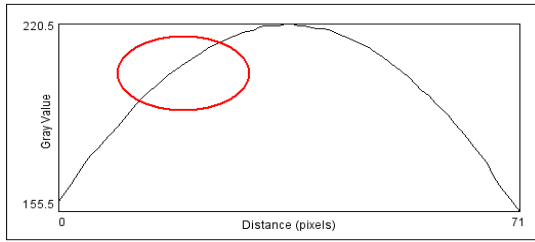
(a) - Perfil do cilindro C2 com Grade Senoidal em 200 linhas por mm
