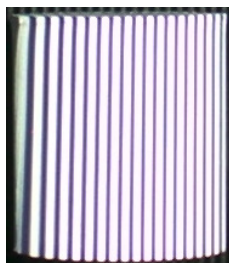
Figura 27. Cilindro com projeção de grade Ronchi de 100 linhas/mm
