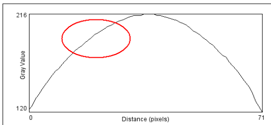
(a) - Perfil do cilindro C2 com Grade Ronchi em 200 linhas por mm
