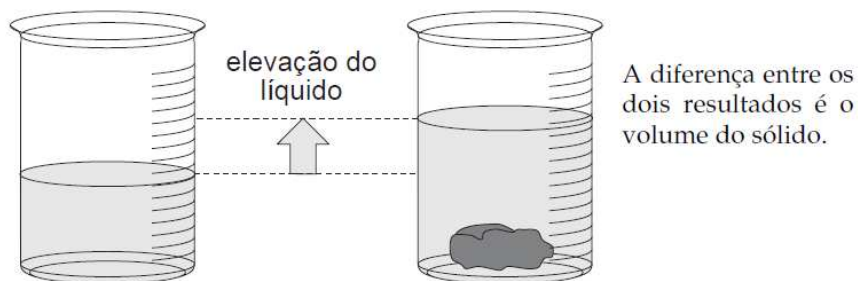
Figura 22. Método de determinação de volume por deslocamento de fluido.
