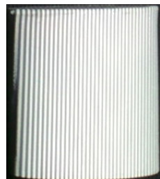
Figura 30. Cilindro com projeção de grade senoidal de 200linhas/mm
