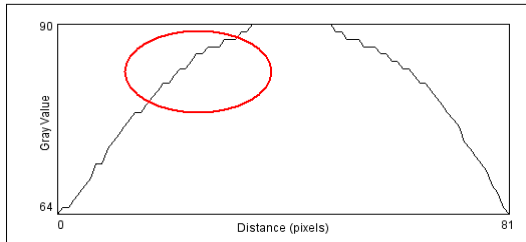
(a) - Perfil do cilindro C2 com Grade Ronchi em 100 linhas por mm.
