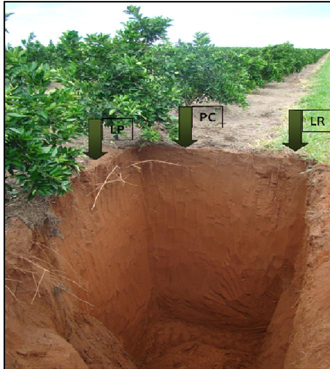
**Figura 3.** Trincheira com as posições de coletas de amostras de solo.
