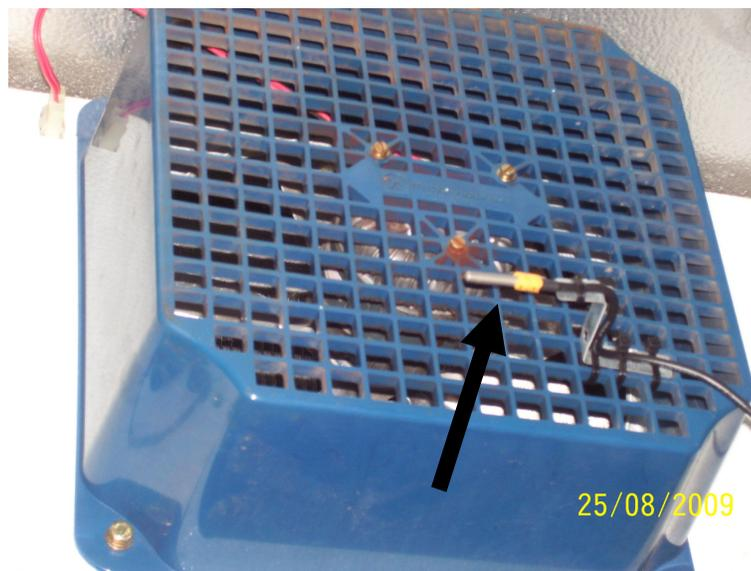
Figura 17: Sensor de temperatura - Pt100
