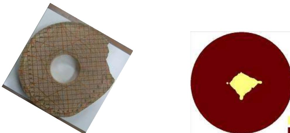
Figura 4.36 Foto da peça de Pequiá com 35% de oco e imagem produzida com a malha reticulada.
