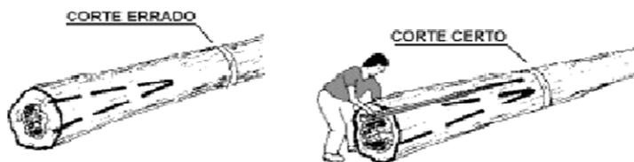
Figura 2.1 Estimativa do comprimento do oco na tora. Fonte: Amaral *et. al.* (1998)
