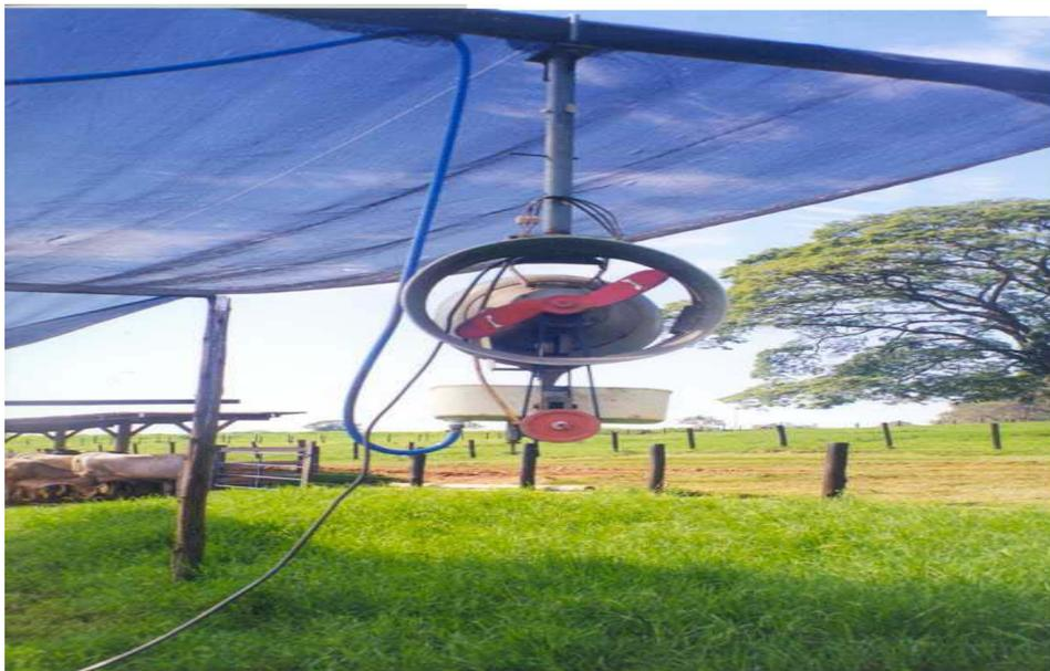
Figura 10. Aspersor ventilador –vista posterior
