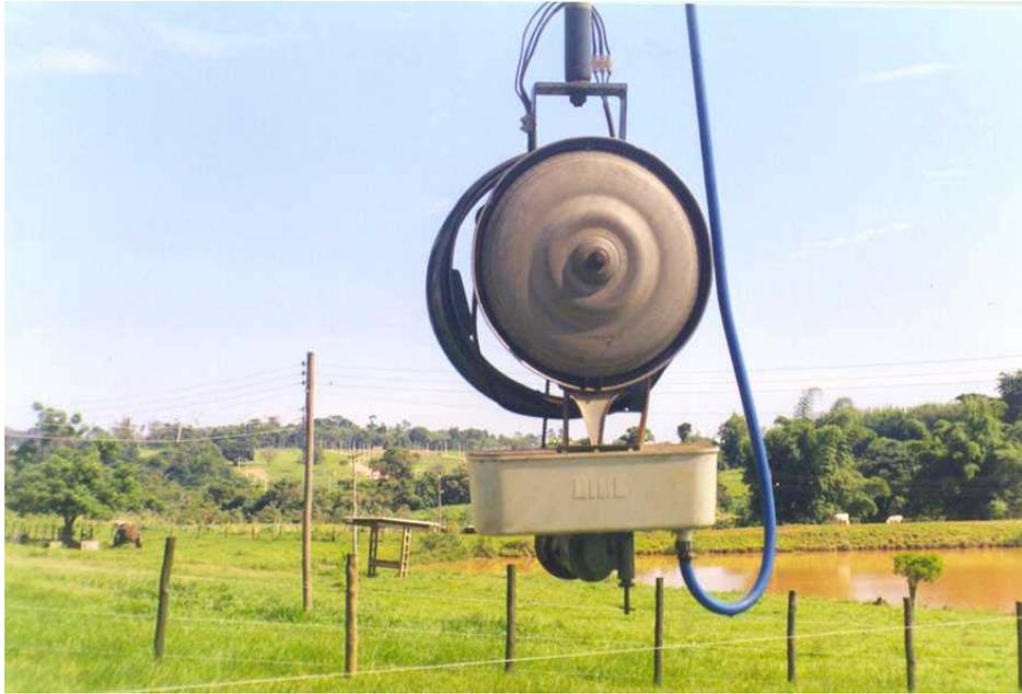
Figura 9. Aspersor ventilador utilizado no tratamento 3
