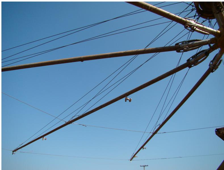
**Figura 8.** Hastes do simulador, com destaque para visualização dos bicos aspersores.
