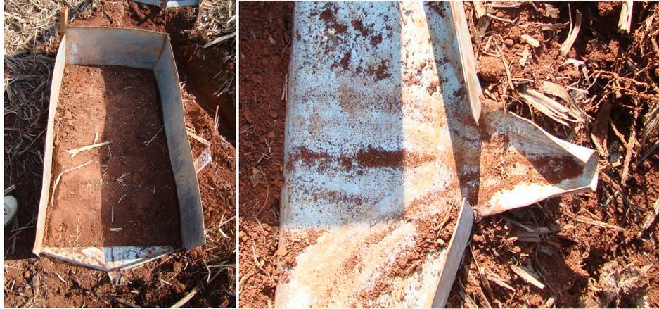
**Figura 6.** Parcela experimental, em destaque no lado direito a saída da calha coletora.
