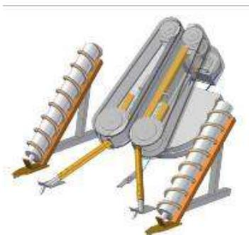
**Figura 13 – Projeto mecânico da frente de corte e alimentação.**
