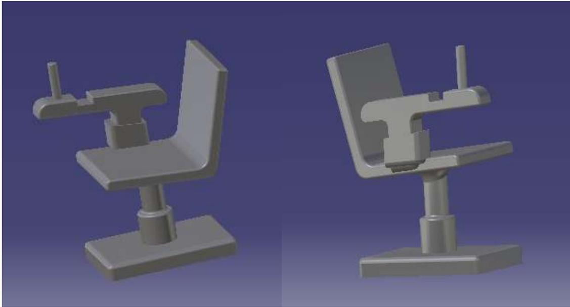
**Figura 27 – Layout do assento e seu apoio de braço com regulagem**
