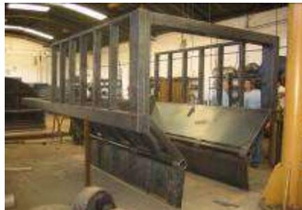
**Figura 15 – Protótipo da unidade de limpeza e da carreta armazenadora.**
