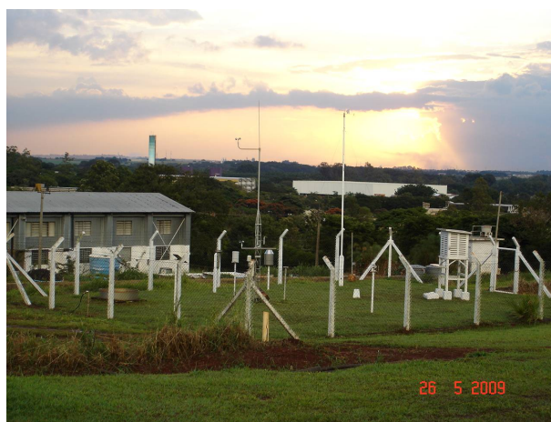
Figura 15. Estação meteorológica localizada a 100 metros do experimento FEAGRI/UNICAMP.
