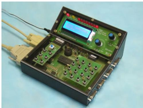
Figura 26: Placa de desenvolvimento de aplicações am microcontroladores utilizada no projeto (EXSTO, 2005).
