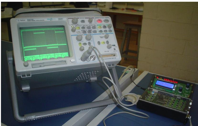
Figura 34: Esquema da montagem do teste preliminar do sinal de saída do programa de controle
