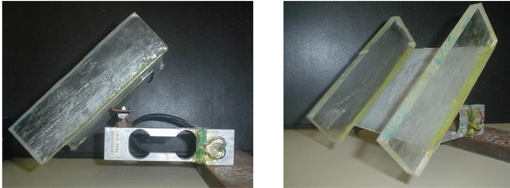
Figura 42: Sistema físico de aquisição: (a) Vista lateral da célula de carga com anteparo; (b) visão em perspectiva
