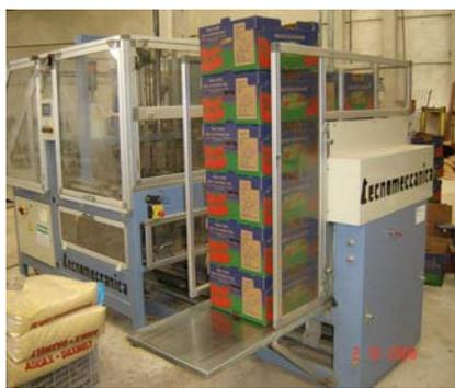
**Figura 20–Montadora de caixas**
