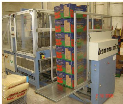
**Figura 44 – Montadora de caixas**
