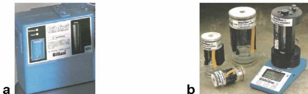
Figura 14. Bomba de coleta de poeira (a) e calibrador eletrônico(b).
