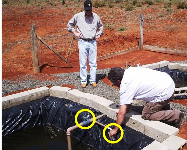
Figura 17 – Coleta da amostra de efluente da lagoa anaeróbia.
