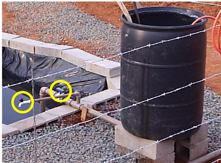
Figura 16 – Tanque plástico com registro e a torneira lateral para coleta de amostras
