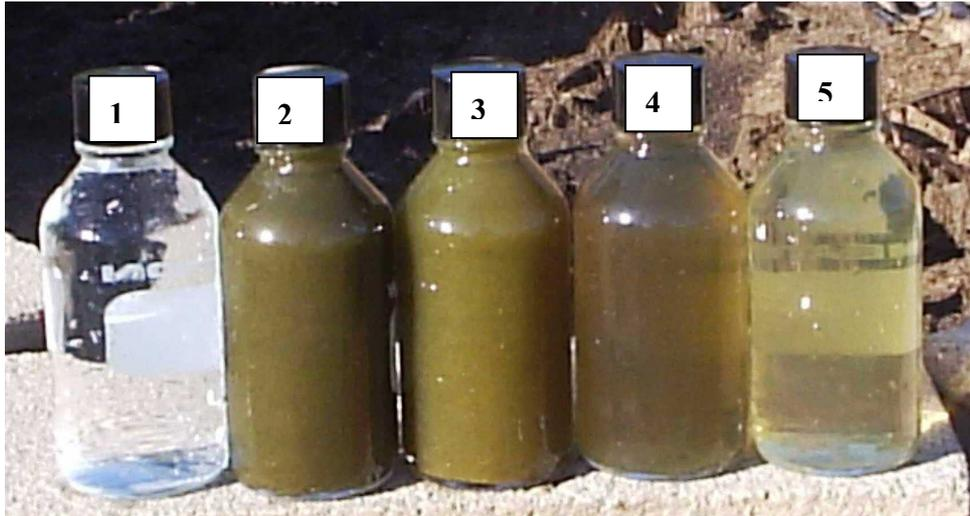
Figura 29 – Aparência das amostras dos efluentes coletadas nas unidades da ETE piloto – Frasco (1) amostra da água usada para diluir os dejetos e transformá-los em efluente bruto; frasco (2) amostra de efluente bruto; frasco (3) amostra do efluente da lagoa anaeróbia; frasco (4) amostra do efluente da lagoa facultativa; frasco (5) amostra do efluente do leito cultivado.
