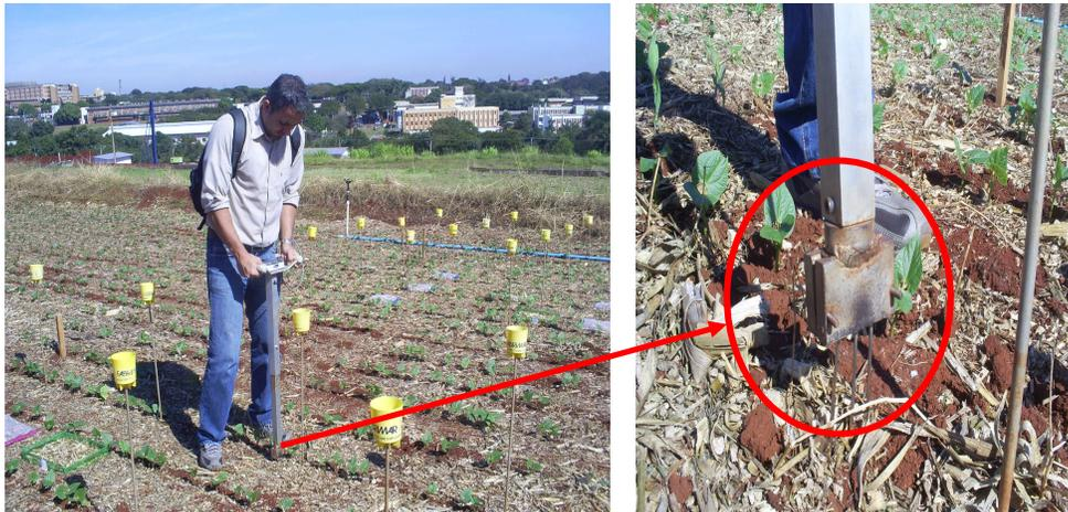
Figura 3. Leitura da umidade do solo e condutividade elétrica por sonda de TDR e detalhe da sua fixação no equipamento portátil.
