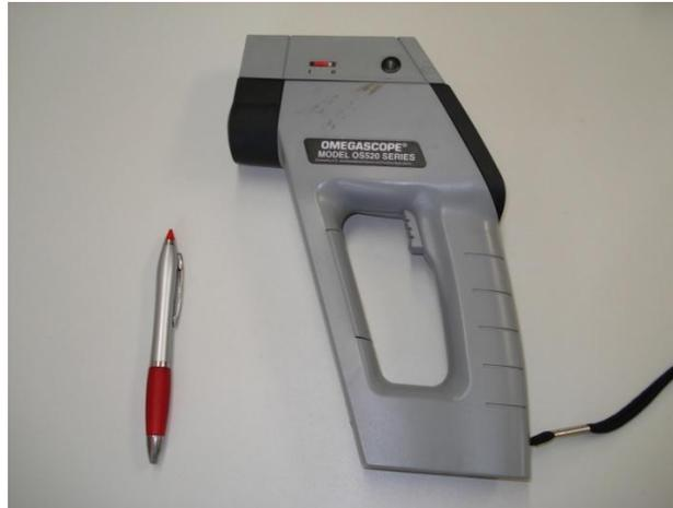
Figura 19 Termômetro digital de superfície Omegascope®, modelo OS520.
