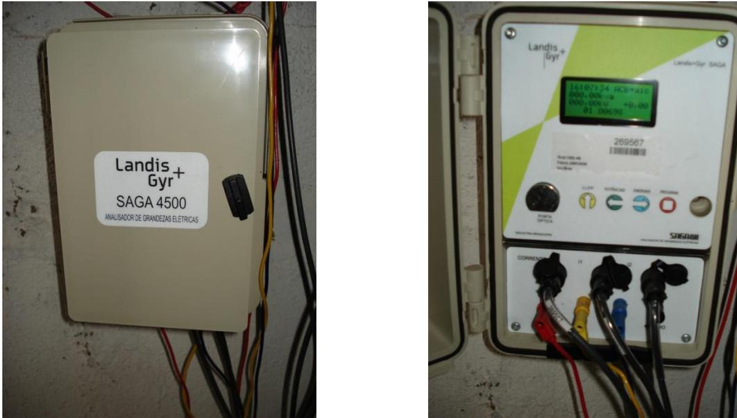
Figura 23 Analisador e registrador eletrônico de sistemas elétricos monofásicos ou trifásicos SAGA4500 AMPFLEX
