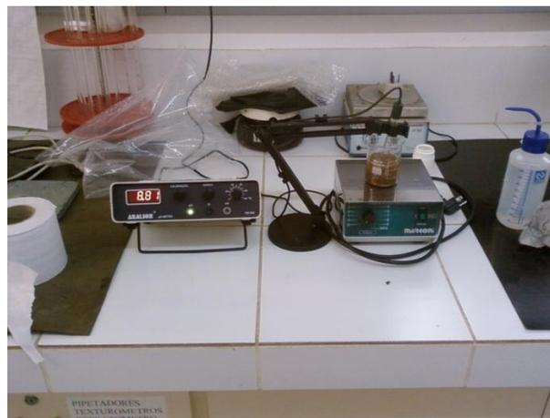
Figura 18 Amostra homogeneizada para leitura de pH em pH-metro digital
