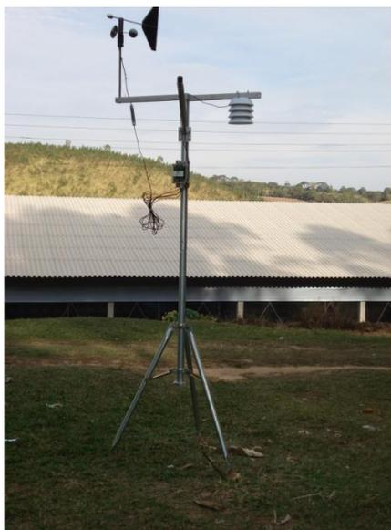
Figura 17 Estação meteorológica, Modelo WMR 928 Oregon®.
