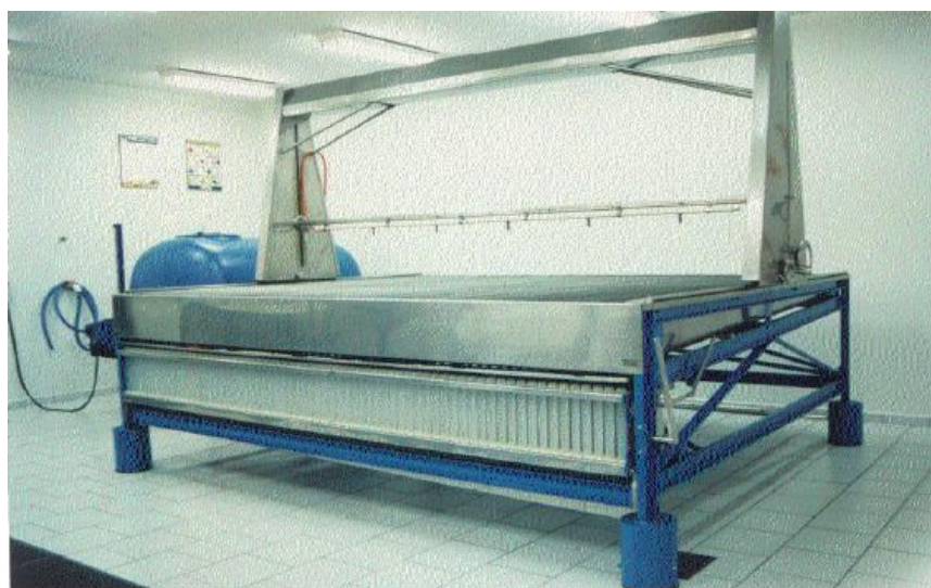
Figura 22 Bancada para análise da distribuição transversal de bicos de pulverização.
