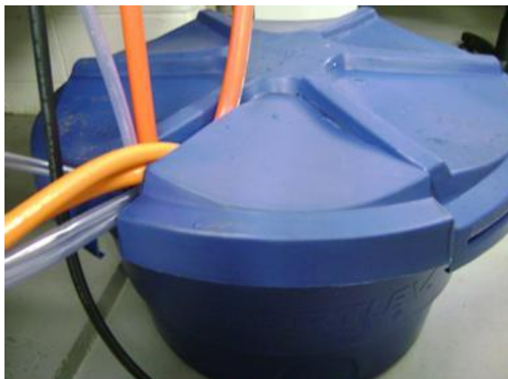
Figura 24 Ilustração do reservatório com um “pulmão” de 100L usado na bancada.
