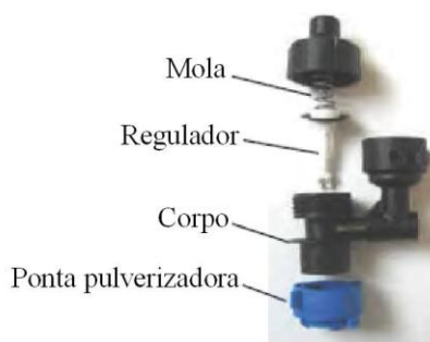
Figura 18 Componentes do bico VariTarget.
