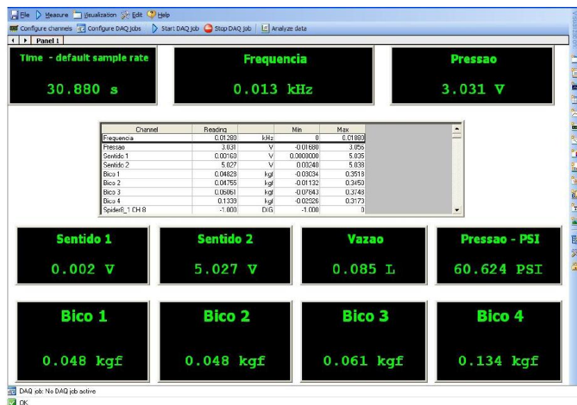
Figura 43 Interface configurada no software Catman do Spider para fazer a aquisição de dados das balanças.
