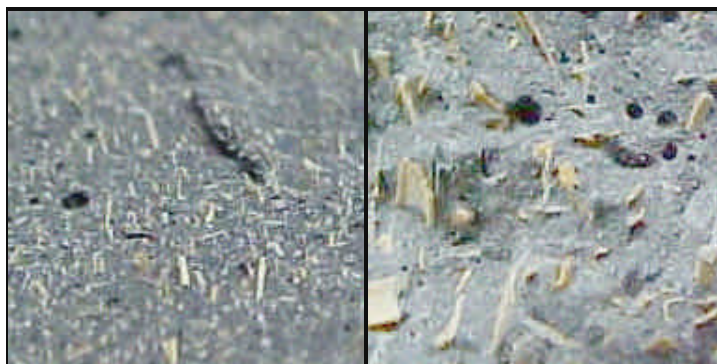
Figura 69: Dispersão das partículas de casca #100-20% e #16-35% na pasta de cimento.
