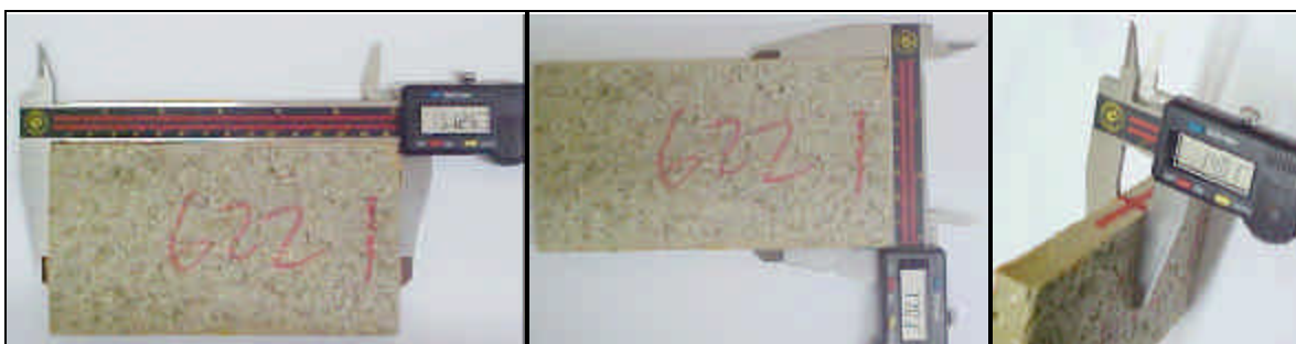
Figura 58: Ensaio de absorção e variação dimensional: determinação de medidas.
