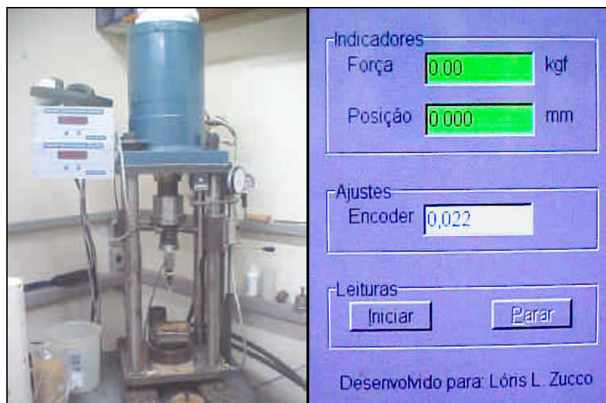
Figura 31: Prensa instrumentada: Visão geral e tela do software de gerenciamento.
