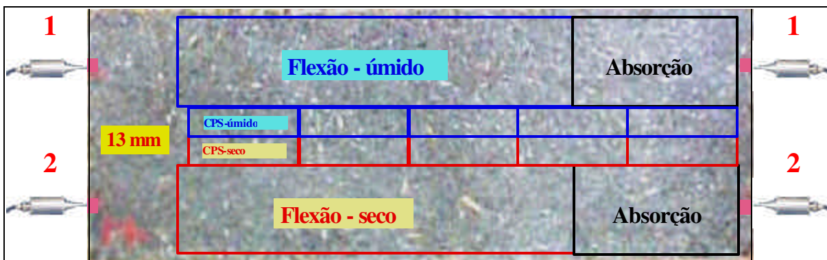
Figura 54: Esquema do corte das placas para obtenção dos corpos-de-prova e indicação das posições dos transdutores de ultra-som para acompanhar a EVPU.
