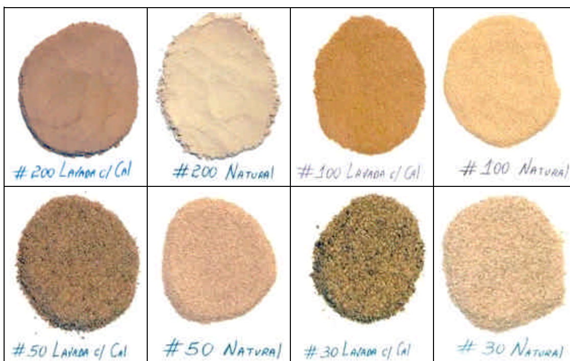
Figura 3: Algumas faixas de distribuição em tamanho das partículas empregadas nas curvas de hidratação. A cor mais escura é característica na casca lavada em solução de cal.
