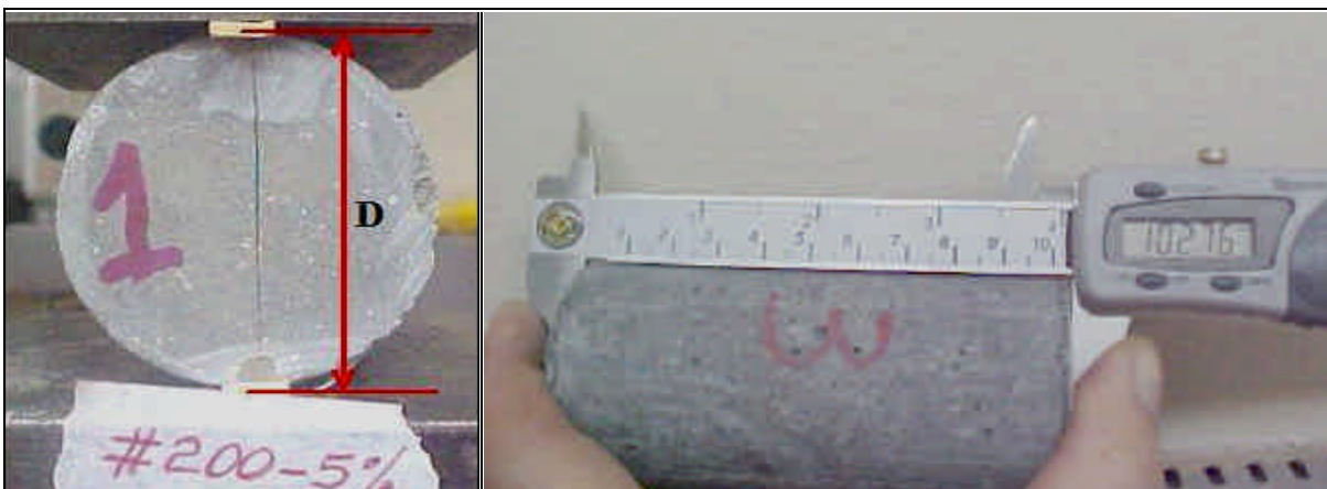
Figura 51: Determinação das dimensões dos corpos-de-prova cilíndricos: diâmetro, para o ensaio de tração por compressão diametral, e altura.
