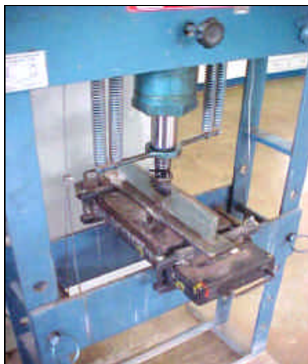
Figura 37: Prensa Hidráulica e fôrma para moldagem das placas de compósito.
