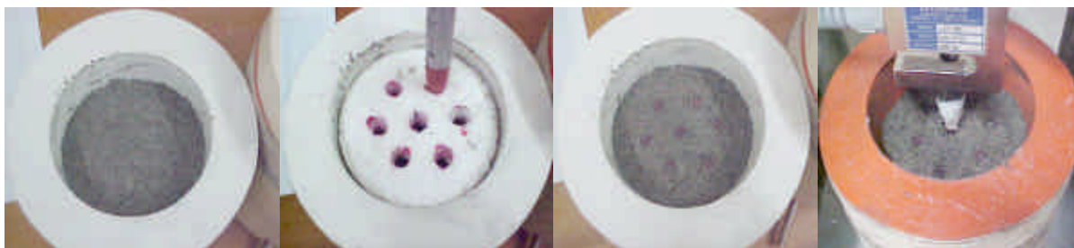
Figura 45: Etapas do ensaio de resistência à penetração: compactação, marcação e ensaio.
