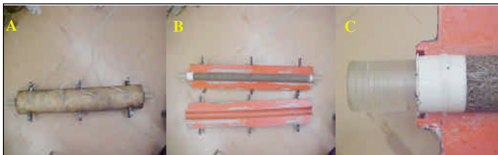
Figura 35: UTS e sensores (A); desmoldagem do cilindro de mistura (B); Detalhe do sistema de acoplamento do sensor de ultra-som na extremidade da UTS.
