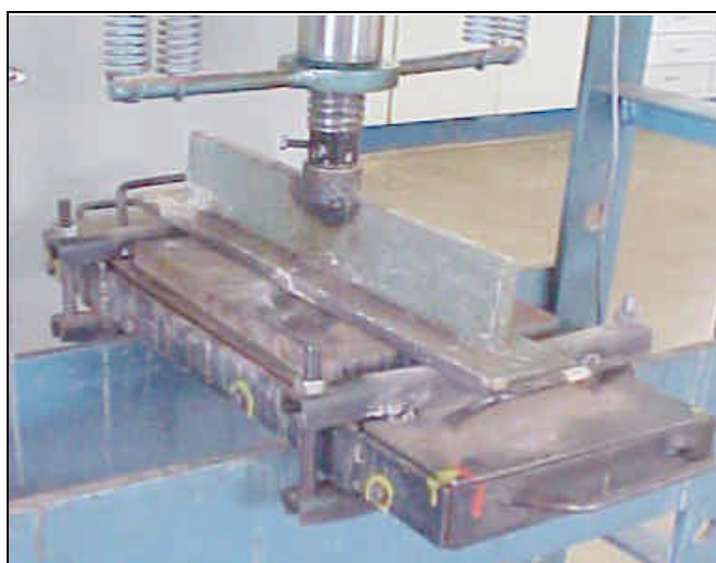
Figura 39: Fôrma utilizada na confecção de placas: travamento e distribuição da carga.
