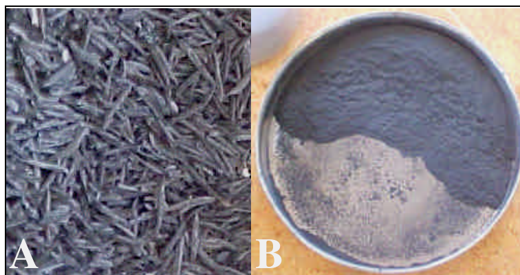
Figura 22: Cinza da casca de arroz: A = natural; B = após ser moída e peneirada (passante em peneira 0,149 mm).
