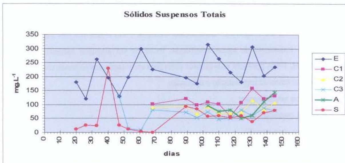
Figura 21 Remoção dos sólidos suspensos totais em reator compartimentado anaeróbio/aeróbio salientando a redução se sólidos entre a entrada do reator (E) e a saída da primeira câmara (C 1 ), de maior volume, onde: E - entrada, C 1 - primeira câmara, C 2 - segunda câmara, C 3 - terceira câmara, A - compartimento aeróbio, S - saída (Adaptado de ZANELLA, 1999)
