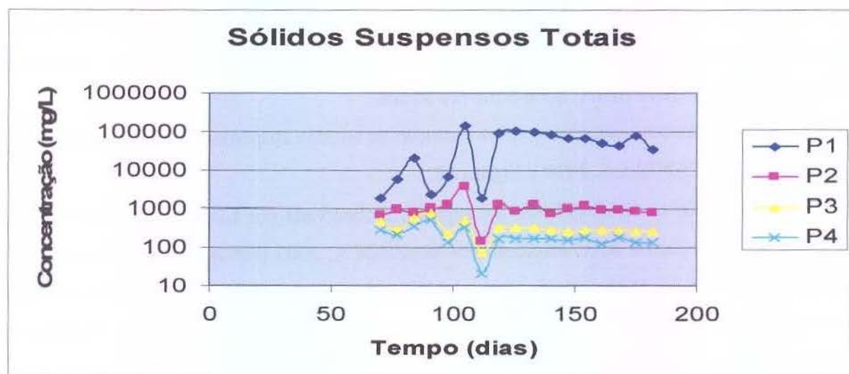
Figura 76 Valores de sólidos suspensos totais nos 4 pontos de coleta durante o período de 112 dias de operação do sistema (17/04 a 07/08/06) onde: P 1 entrada do sistema; P 2 entrada no RAC; P 3 entrada no leito cultivado; P 4 lançamento final
