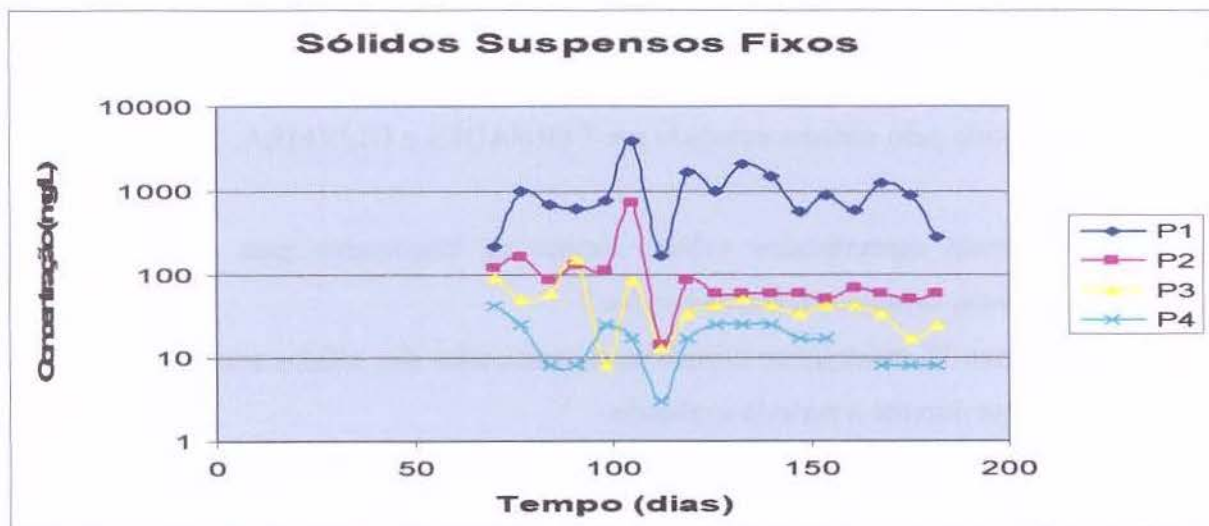
Figura 77 Valores de sólidos suspensos fixos nos 4 pontos de coleta durante o período de 112 dias de operação do sistema (17/04 a 07/08/06) onde: P 1 entrada do sistema; P 2 entrada no RAC; P 3 entrada no leito cultivado; P 4 lançamento final
