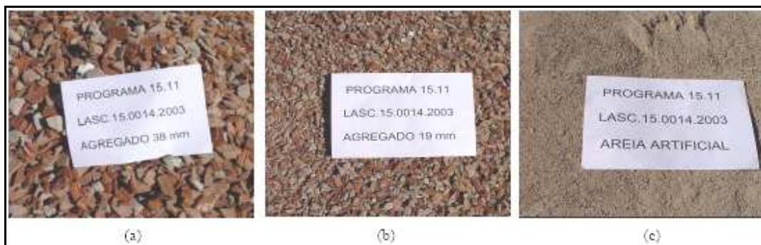
Figura 47. Materiais estudados para utilização em bases e sub-bases a partir do RCD (a) 19mm; (b) brita de 9,5mm; (c) areia artificial, Fonte: LEIVE et al., (2005). p. 40.
