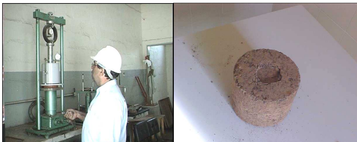
Figura 57. Corpo de prova na prensa de CBR no laboratório da SEMOB em Piracicaba -SP.
