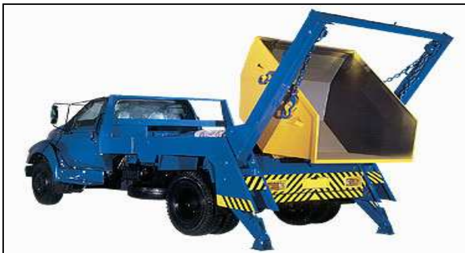
Figura 51. Poliguindaste para remoção de caçambas metálicas.
