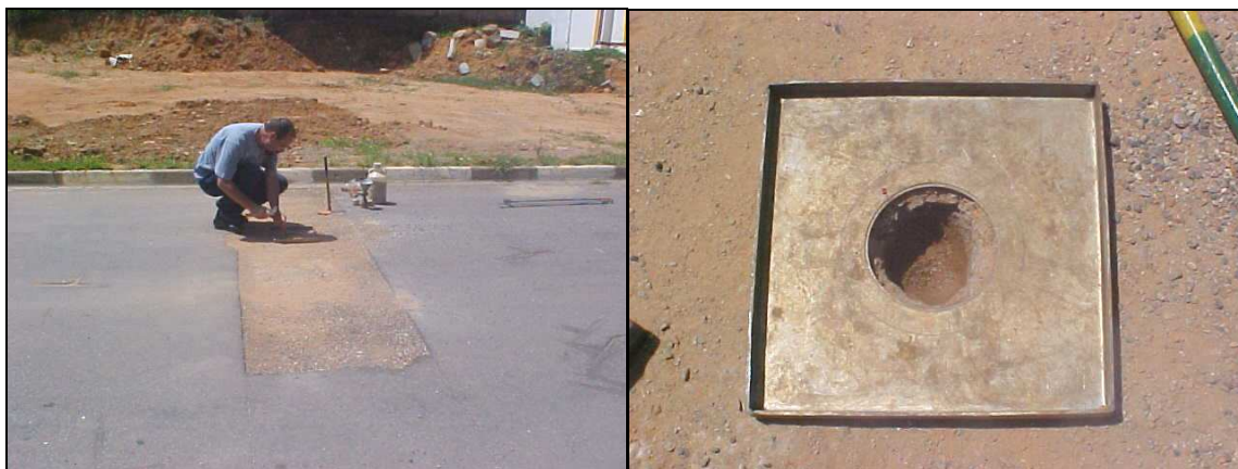
Figura 63. Realização do ensaio do frasco de areia para verificação do grau de compactação.
