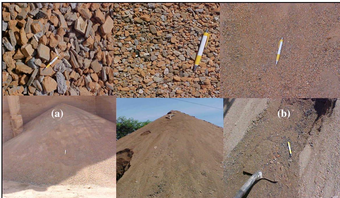
Figura 34. Diferentes tipos de agregados produzidos em uma usina de reciclagem.
