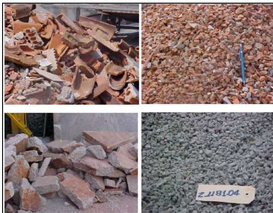
Figura 36. RCD (resíduos de construção e demolição) de concreto e cerâmica antes e após a britagem Fonte: OLIVEIRA et al., 2005, p. 92.
