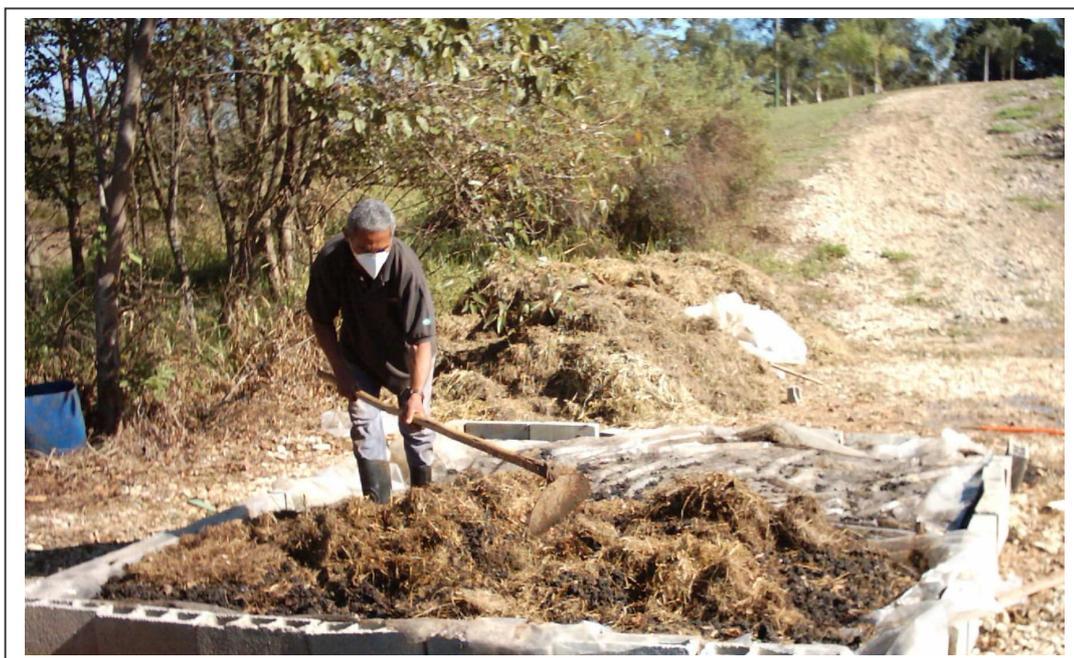
Figura 4 : Momento da mistura do lodo de esgoto com resíduo estruturante.
