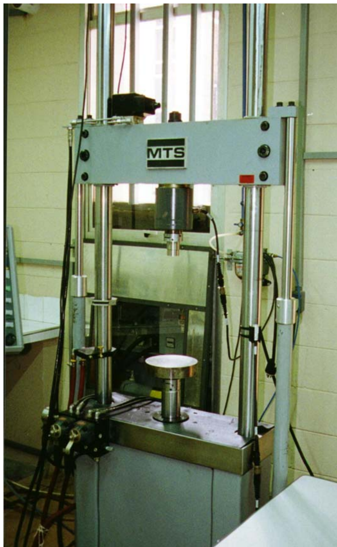
Figura 14. Máquina Universal de ensaios MTS.
