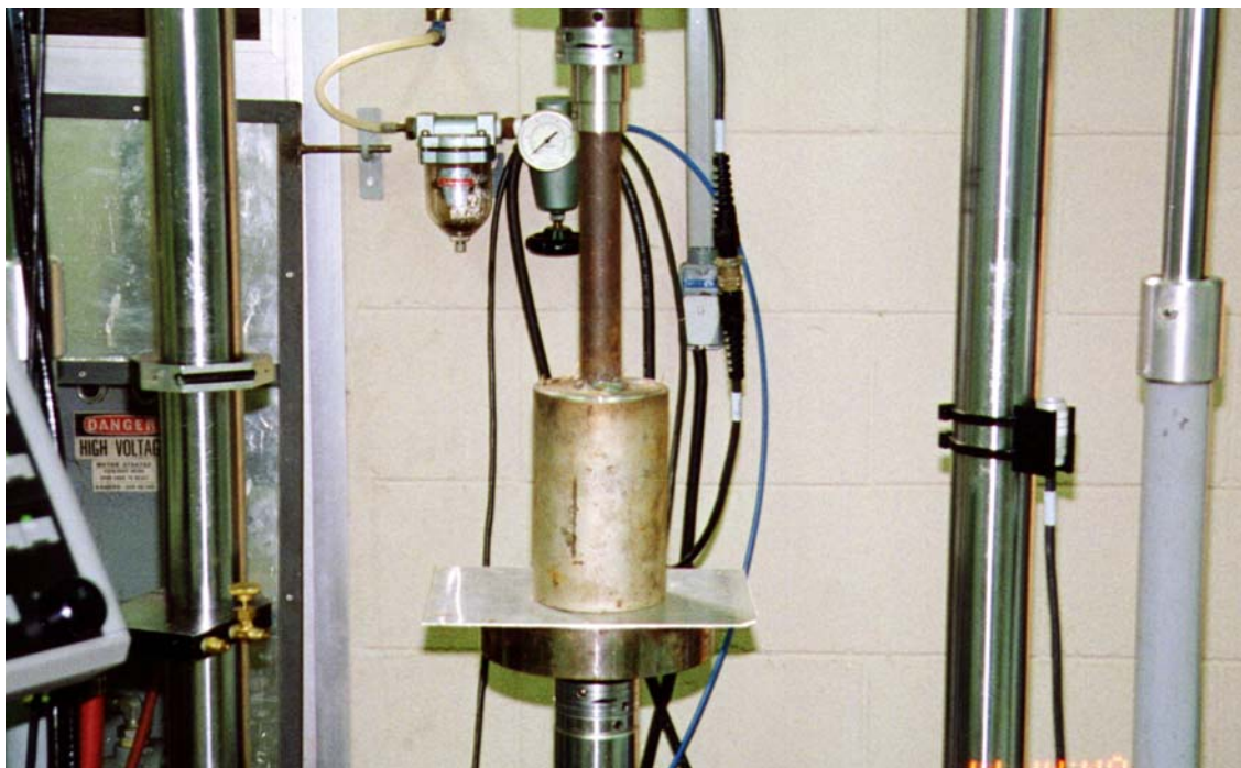
Figura 15. Êmbolo com superfície superior alinhada com o cilindro.
