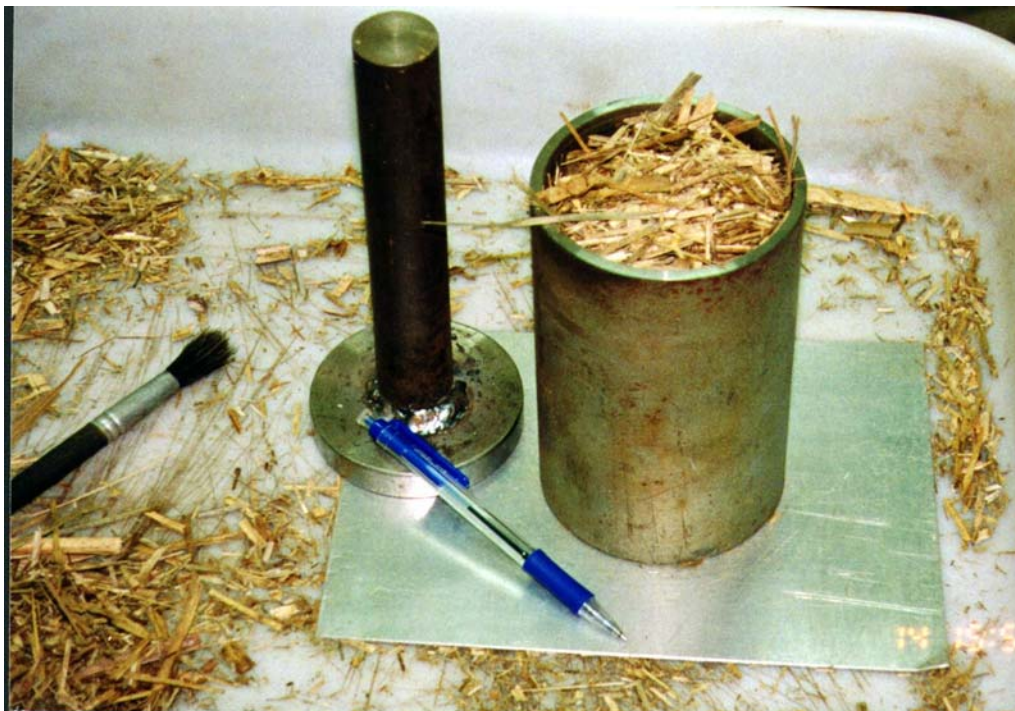
Figura 13. Palhiço de cana-de-açúcar acondicionada no interior do cilindro.
