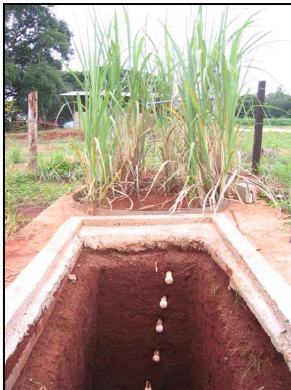
Figura 12 – Lisímetro montado no campo experimental da FEAGRI (janeiro 2007)
