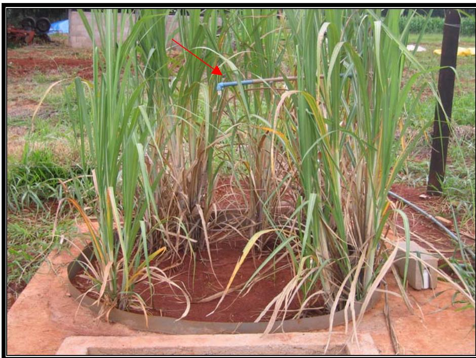
Figura 15 – Detalhe do sistema de irrigação implantado no lisímetro.
