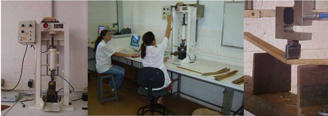
Figura 23: Máquina de ensaio utilizada para o ensaio de flexão estática.
