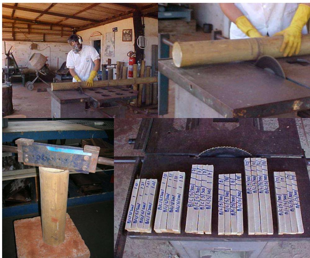
**Figura 13:** Divisão dos colmos inteiros em três partes: basal, mediana e apical; com auxílio de serra circular e extração das taliscas.
