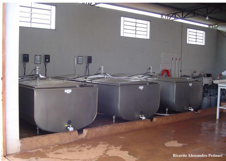
FOTO 8 – Tanques para resfriamento do leite, 2006.
