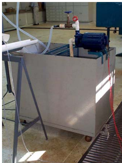
Figura 11. Moto bomba e reservatório de abastecimento.
