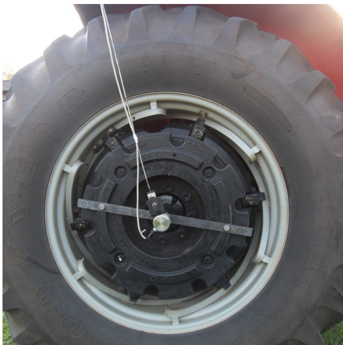
Figura 15 – Encoder instalado na roda do trator para medir o deslocamento
