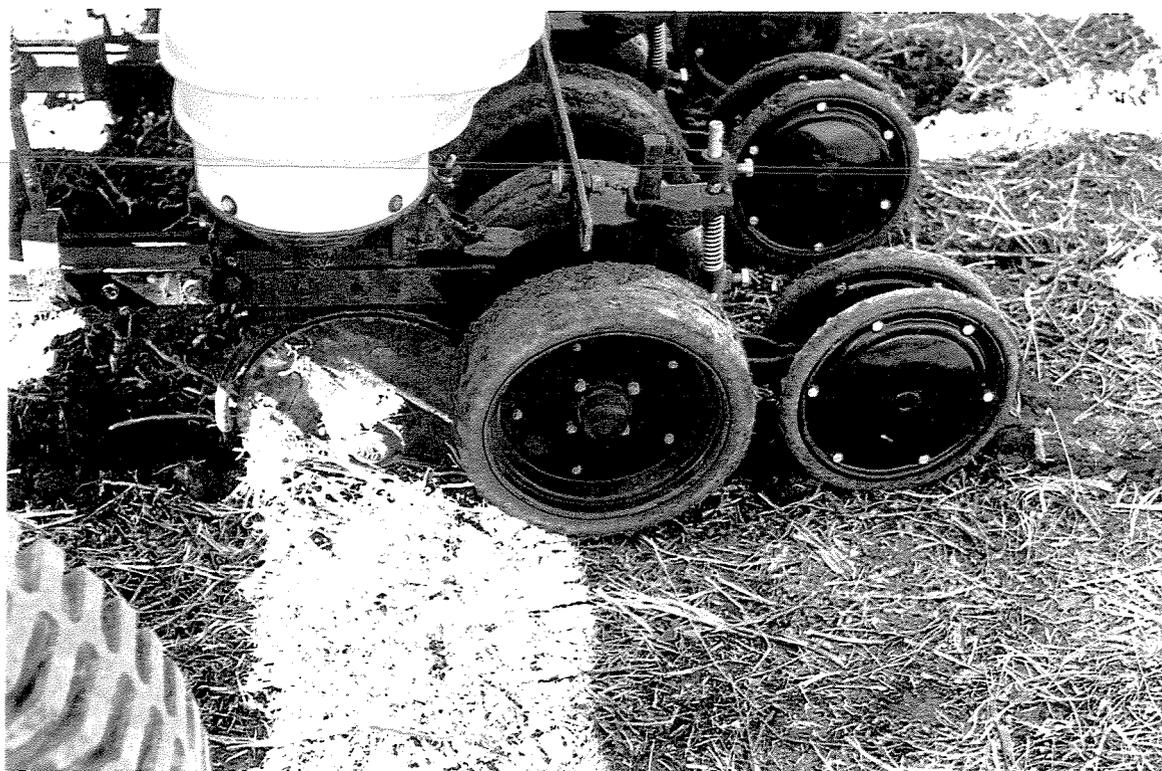
Figura 2 - Detalhe das rodas controladoras de profundidade e das rodas compactadoras do sulco, em formato de um "V".
