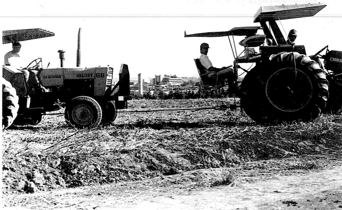
Figura 9 - Detalhe do posicionamento paralelo do cabo de aço em relação à superfície do solo.
