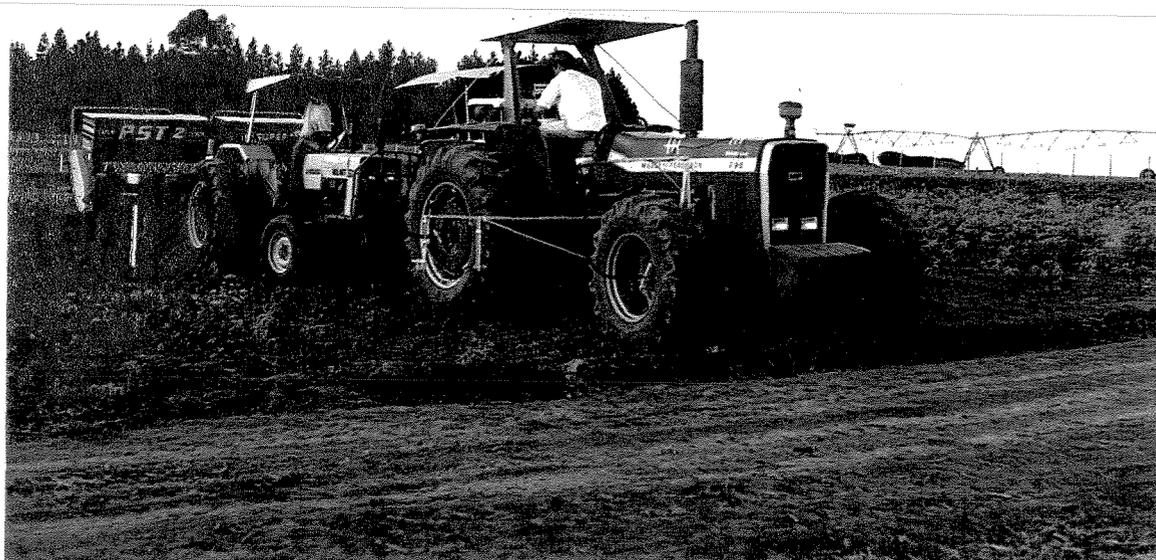
Figura 8 - Vista geral do comboio integrado pelo trator rebocador, que suportava toda a instrumentação, e semeadora-adubadora, acoplada ao trator auxiliar
