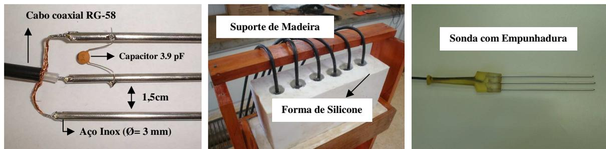
Figura 1. Módulo para montagem das sondas com empunhadura.
