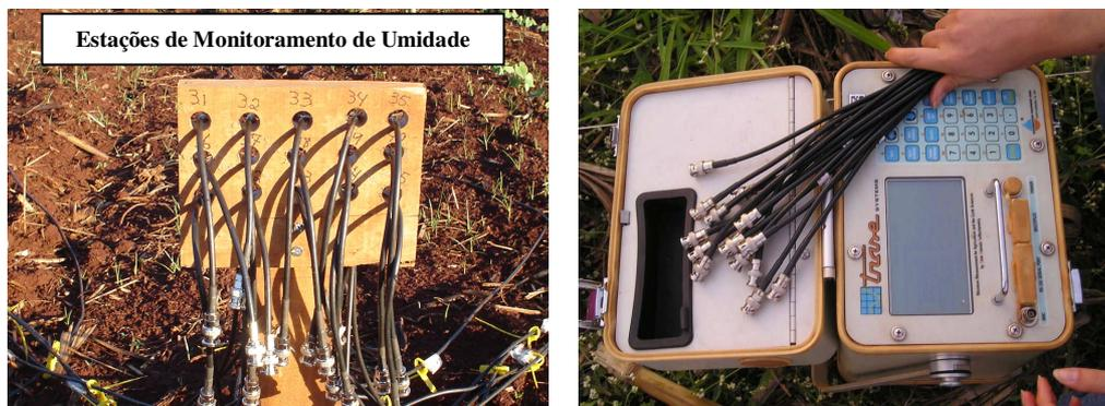
Figura 8. Estações de leitura das 15 sondas no campo e o aparelho Trase System, safra 2005.
