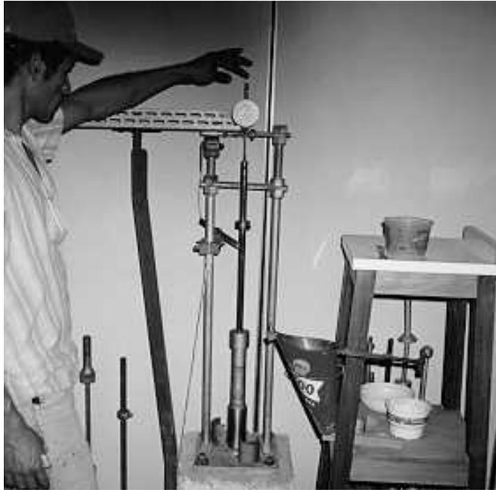
**FIGURA 14** – Dispositivo de medição da altura do corpo-de-prova.
