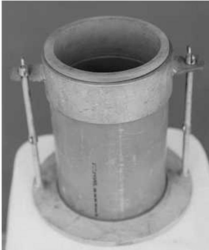
**FIGURA 20** – Molde CBR-Adaptado com colar.
