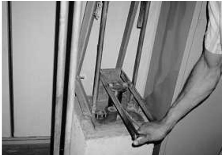
**FIGURA 15** – Dispositivo de extração do corpo-de-prova.
