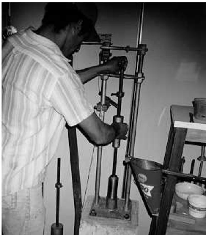
**FIGURA 13** – Detalhe da compactação mini-Proctor.
