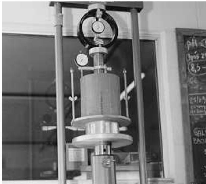
**FIGURA 21** – CBR-Adaptado em operação.
