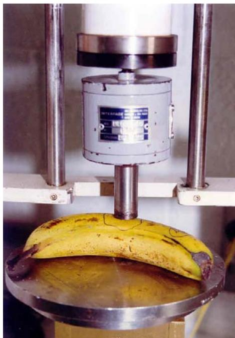
**Figura 8. Ensaio de compressão com ponteira.**
