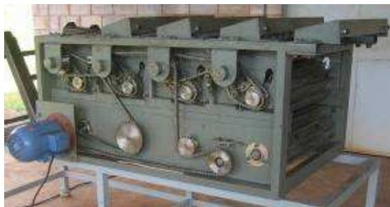
Figura 5 - Unidade de Limpeza [despalhador]1
