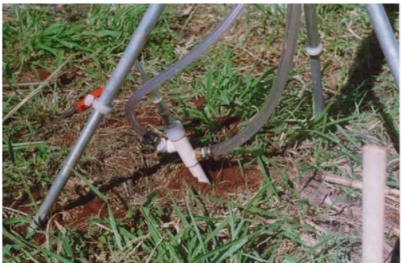
Figura 4.20 Instalação do Permeâmetro de GUELPH, modelo IAC.
