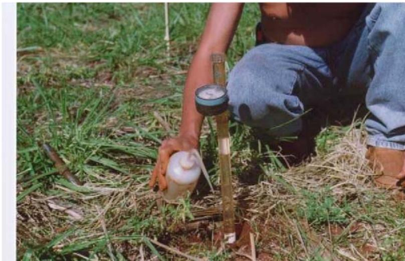
Figura 4.1 – Instalação dos tensiômetros na área experimental
