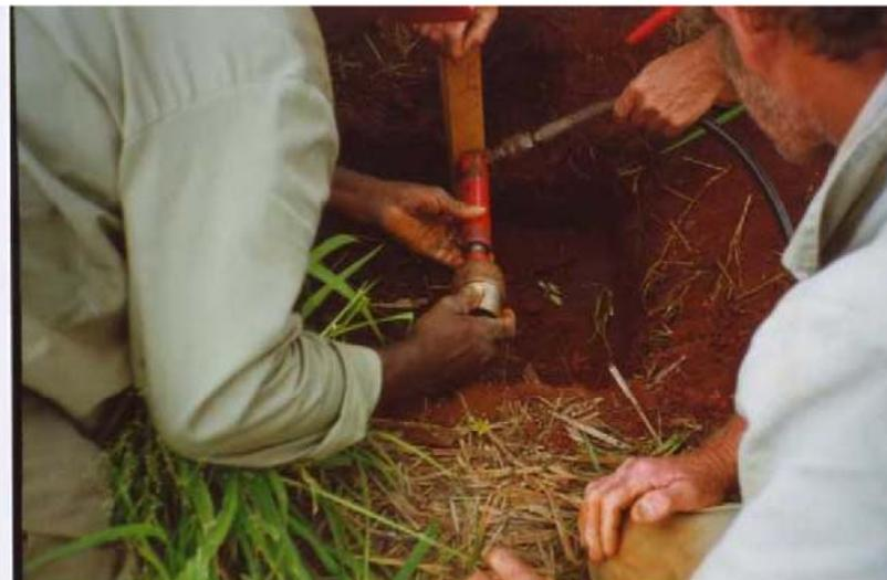
Figura 4.13 - Amostrador hidráulico para coleta da densidade do solo
