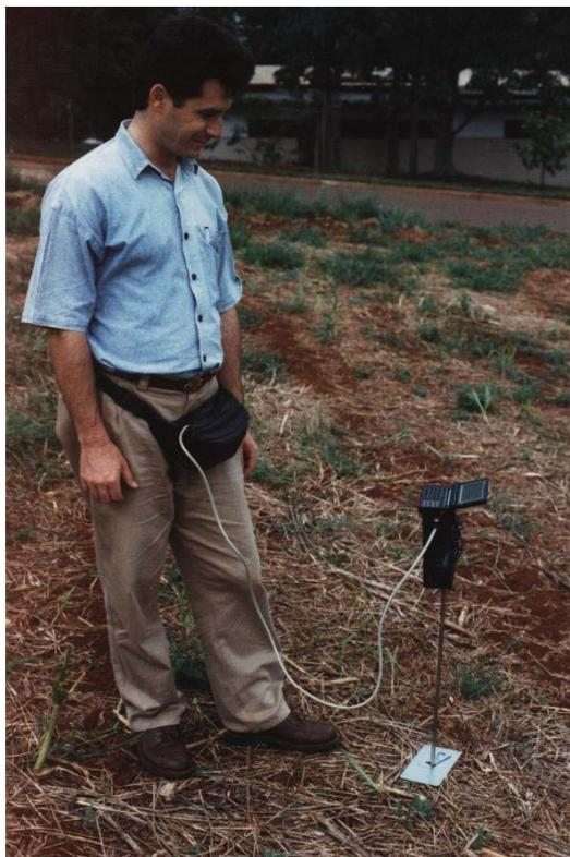
Figura 4.9 – Penetrômetro eletrônico utilizado na coleta de dados.
