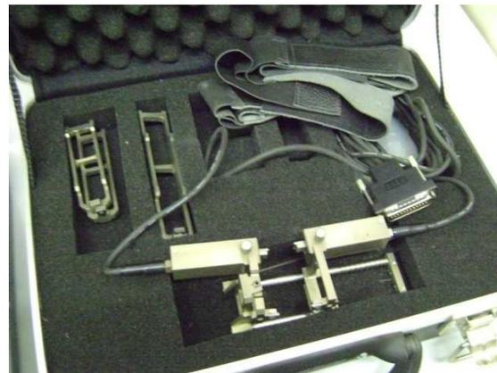
Figura 3.9. Extensômetros para medições de deformações nos corpos-de-prova
