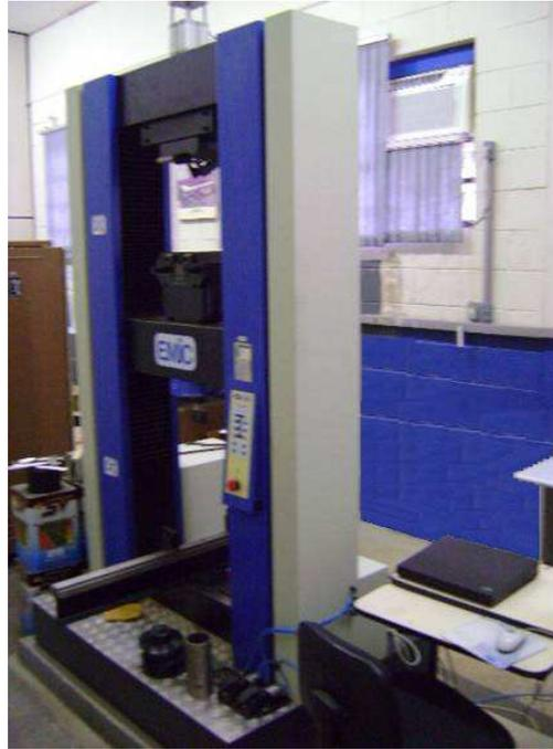
Figura 3.8. Máquina universal de ensaios de capacidade 300 kN
