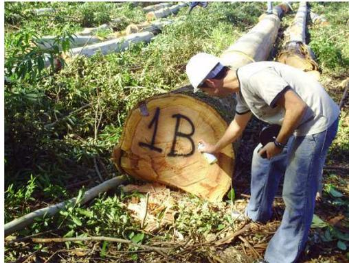
Figura 3.12. Identificação do número da árvore e da posição de retirada em relação ao comprimento (*Eucalyptus grandis*).
