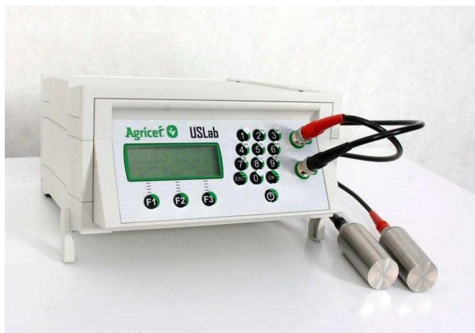
Figura 3.5. Equipamento de ultrassom USLab
