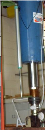
Figura 3.7.b- Potenciômetro
