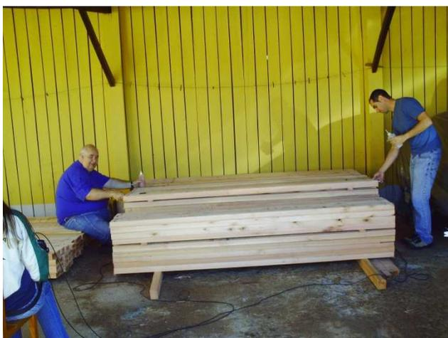
Figura 3.17a. Ensaio de ultrassom logo após o desdobro (ainda na serraria) nas vigas saturadas
