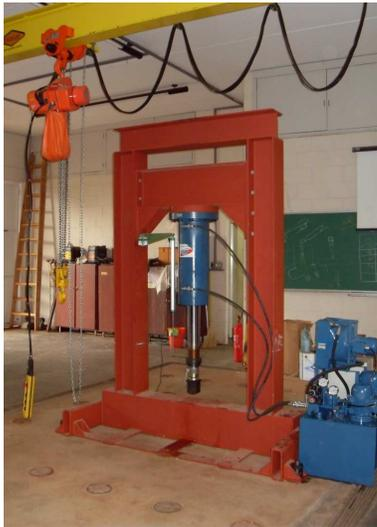
Figura 3.7.a - Pórtico de capacidade de carga de 500 kN
