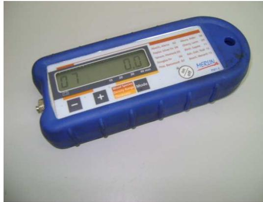
Figura 3.10. Medidor de umidade
