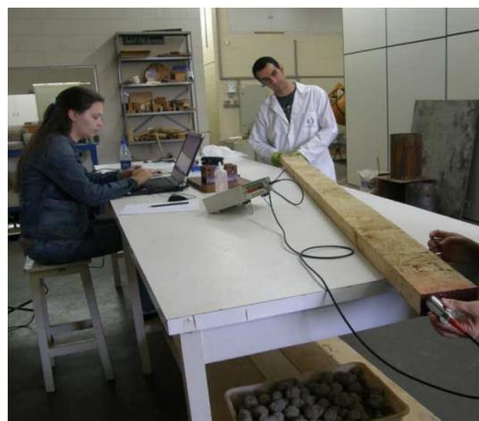
Figura 3.17b. Ensaio de ultrassom nas vigas após secagem (umidade  $\cong$  12%)
