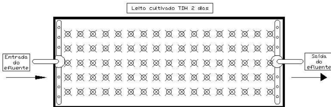
**Figura 4.13:** Representação esquemática do plantio das mudas de taboa no leito com TDH de 2 dias.
