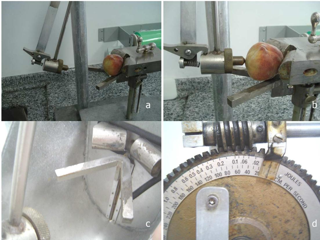
**FIGURA 5.** Detalhes do equipamento de impacto: (a) pêndulo armado para o impacto; (b) pêndulo no momento do impacto; (c) base de apoio e contra-apoio (*back-stop*) e (d) escala de velocidade e energia.
