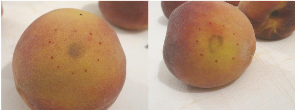
**FIGURA 18.** Marca resultante do contato dos pêssegos com a mesa de vibração – etapa 2, 0,9 G, 18.000 ciclos.
