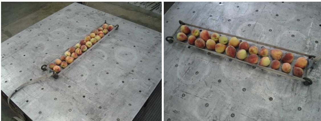
**FIGURA 14.** Ilustração da disposição dos pêssegos sobre a mesa de vibração.
