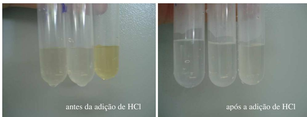
**FIGURA 23.** Ilustração do clareamento das soluções devido à adição de ácido para a interrupção da reação.
