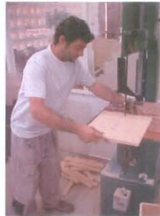
**Figura 32.** Retirada das bordas.
