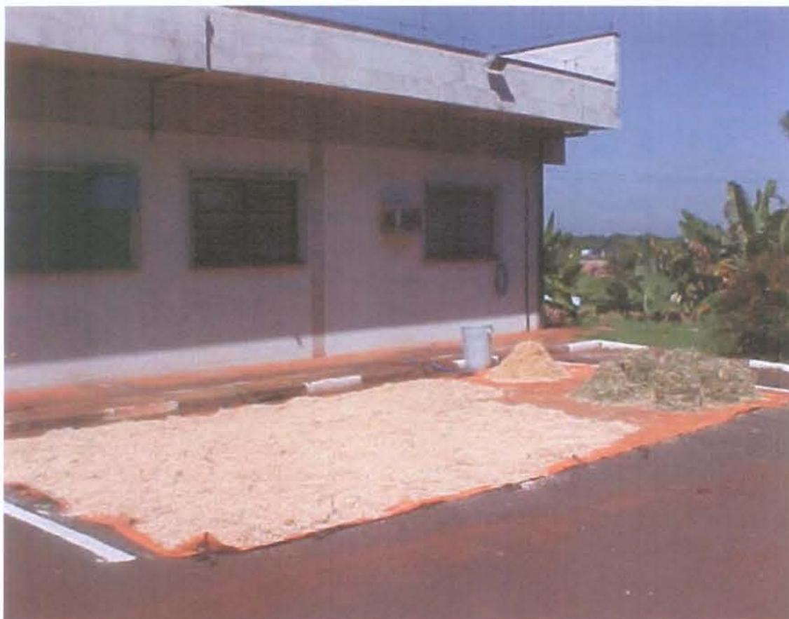
**Figura 18.** Secagem dos pedaços de bambu.
