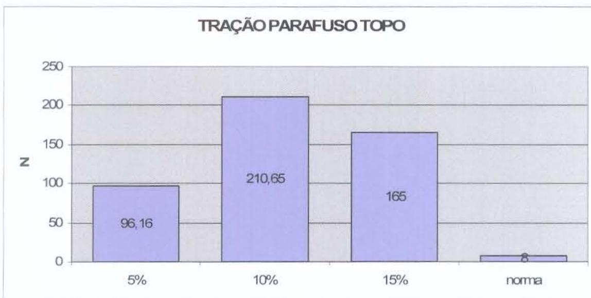
**Figura 57.** Média dos valores de tração de parafuso do topo nas amostras das chapas de partículas de bambu.
