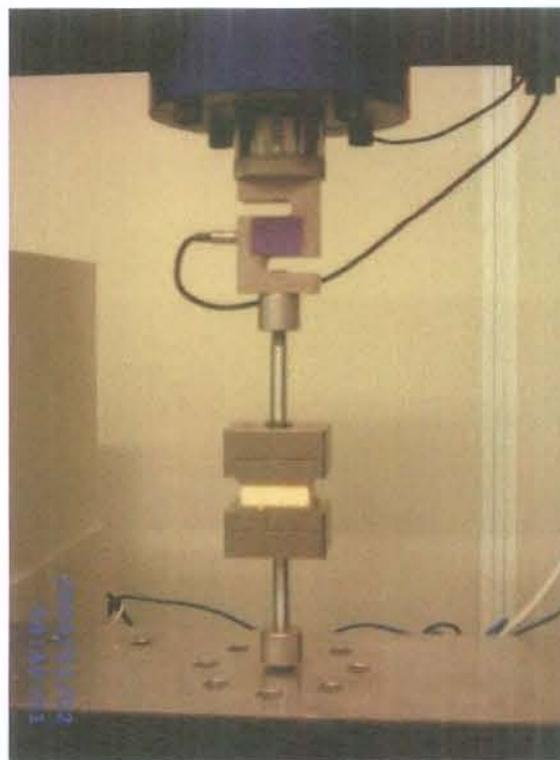
**Figura 46.** Ensaio de tração perpendicular.
