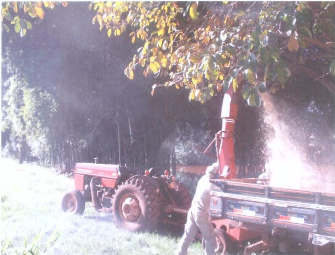
**Figura 14.** Desintegrador agrícola acoplado a um trator.
