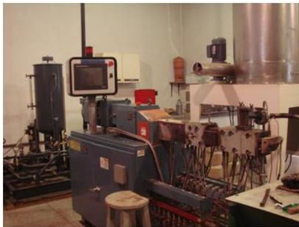
Figura 5. Extrusora dupla rosca, modelo ZKS-25, Werner & Pfleiderer
