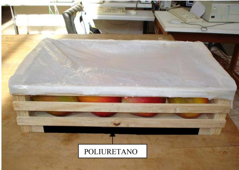
**Figura 4.22:** Embalagem preparada para o experimento de resfriamento rápido.
