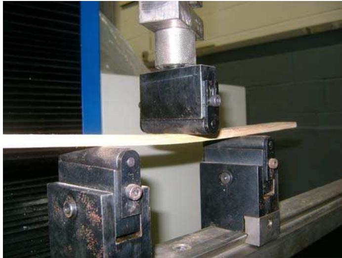
Figura 20. Ensaio de flexão estática.
