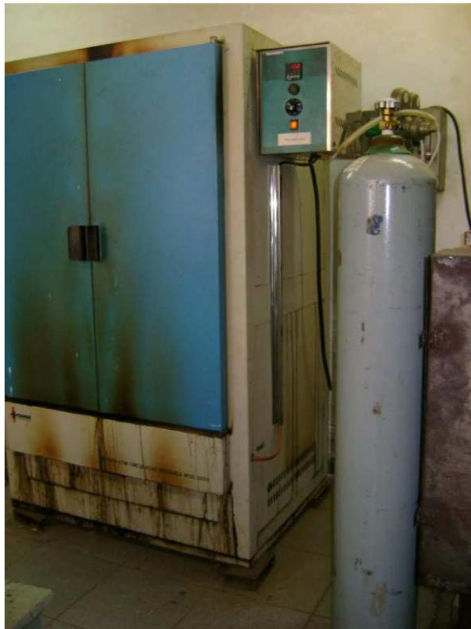
Figura 15. Estufa Marconi, utilizada para aquecimento dos corpos-de-prova.
