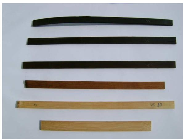
Figura 23. BTR de acordo com a temperatura de tratamento térmico (seco ao ar – controle; 140, 180, 220, 260 e 300 °C (parte superior)).
