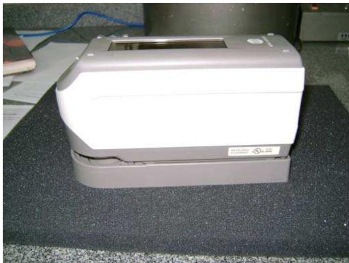
Figura 17. Aparelho CM-2600d / Konica-Minolta para medir parâmetros de cor.
