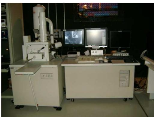
Figura 5. Microscópio Eletrônico de Varredura (MEV) – LNLS.
