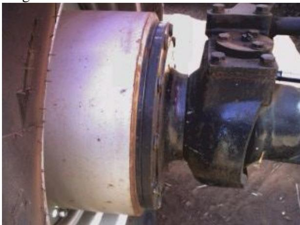
Figura 19. Detalhe do aumento da bitola do eixo
