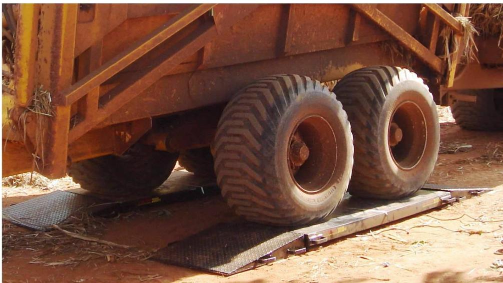
Figura 6. Transbordo sobre a balança para pesagem a campo.
