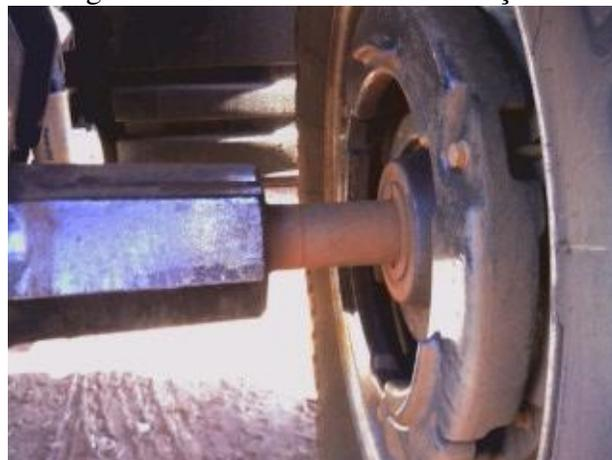
Figura 20. Detalhe do aumento da bitola do eixo
