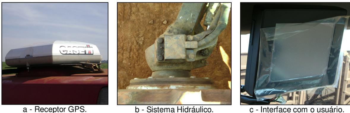
Figura 3. Imagens do sistema de piloto automático.
