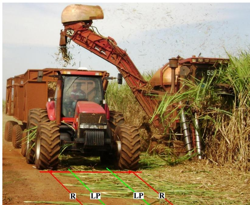
Figura 2. Trator com bitola estendida e esquematização da área, sendo (LP) linha de plantio e (R) eixo do rodado do trator.
