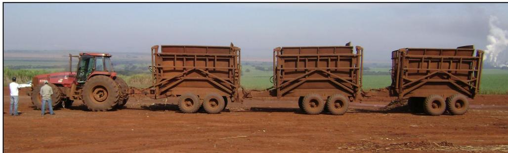
Figura 8. Trator com os transbordos acoplados.
