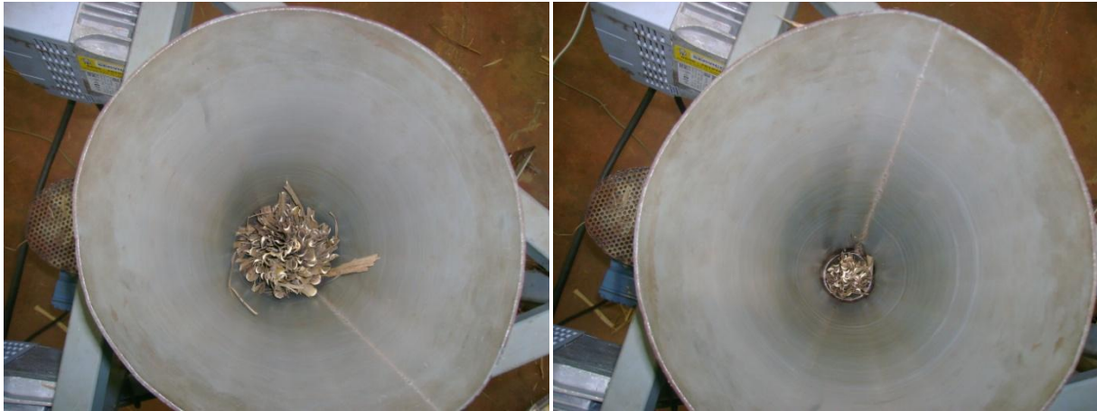
Figura 45: Vista superior do cone alimentador. Força axial necessária para tracionar o feixe pelo gargalo do cilindro torçor.
