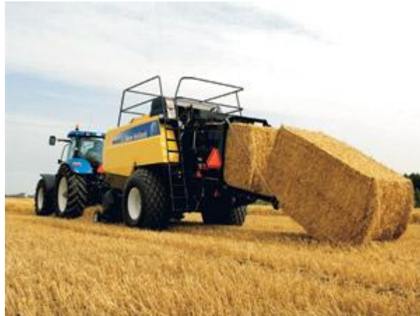
Figura 5: Enfardadora de fardos prismáticos. Fonte: New Holland.
