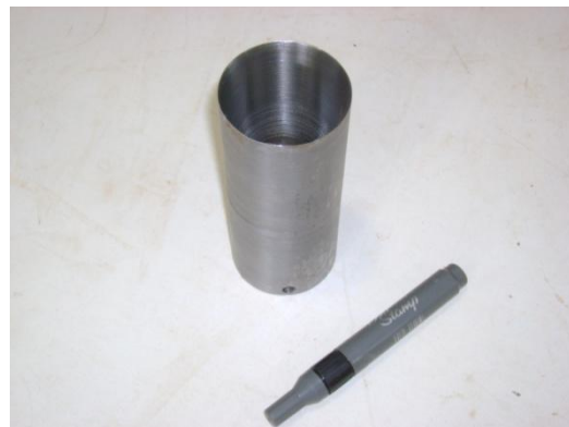
Figura 30: Detalhes do cilindro torção e do dispositivo redutor de diâmetro.
