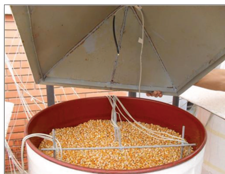
F. Posição do sensor de temperatura e umidade relativa no telhado
