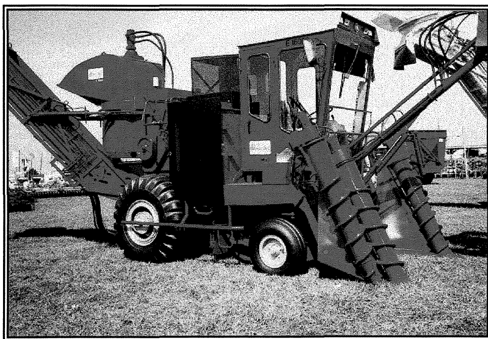
Figura 4 - Colhedora de cana-de-açúcar picada - mod. E-16000 (BRASTOFT).
