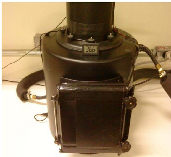
**Figura 6** - Protótipo de contagem biofotônica: 1-PMT, 2-PMT housing, 3-câmara de isolamento, 4-local para amostra biológica.
