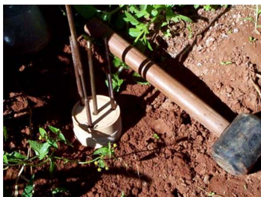
Figura 4: Instalação das hastes da sonda, usando uma guia de PVC.
